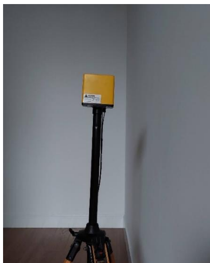
Slika 1. Položaj sonde za merenje magnetske indukcije u stanu (merno mesto 1)
